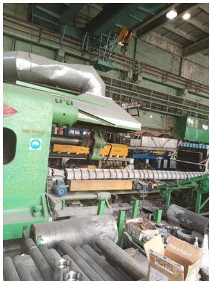
Рис. 7. Випробування трубопресового інструменту на ТОВ «ВО ОСКАР» (м. Дніпро) [14]
